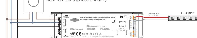
Si plusieurs alimentations sont contrôlées en parallèle, veillez à régler le seuil minimum de variation sur le contrôleur afin d'éviter le phénomène de scintillement.
