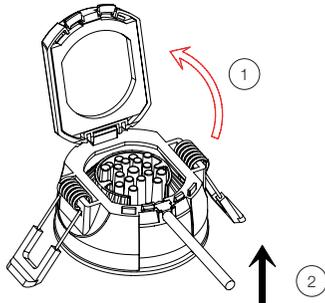
**FR** Retourner le spot. Ouvrir le capot de la face arrière (1). Déclipser le câble d'alimentation de sa gorge de maintien (2).
