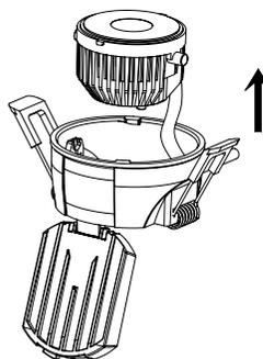
**FR** Presser l'arrière du module LED afin de déclipser l'axe d'orientation. Faire sortir le module LED par la face avant.
