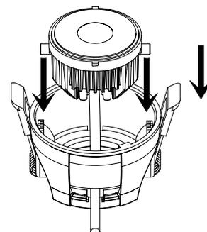
**FR** Remonter le nouveau module dans l'ordre inverse. Positionner l'axe d'orientation dans ses supports, exercer une légère pression sur la face avant afin de le reclipser.
