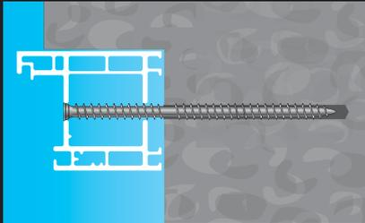
Ø 6.5 pour Fixation avec vis béton
