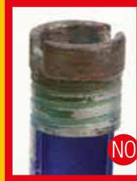
Un échauffement (segment noirci) provoque une diminution du pouvoir de coupe. Il faut raviver l'outil.
