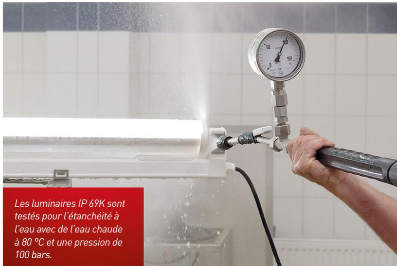
*Les luminaires IP 69K sont testés pour l'étanchéité à l'eau avec de l'eau chaude à 80 °C et une pression de 100 bars.*
