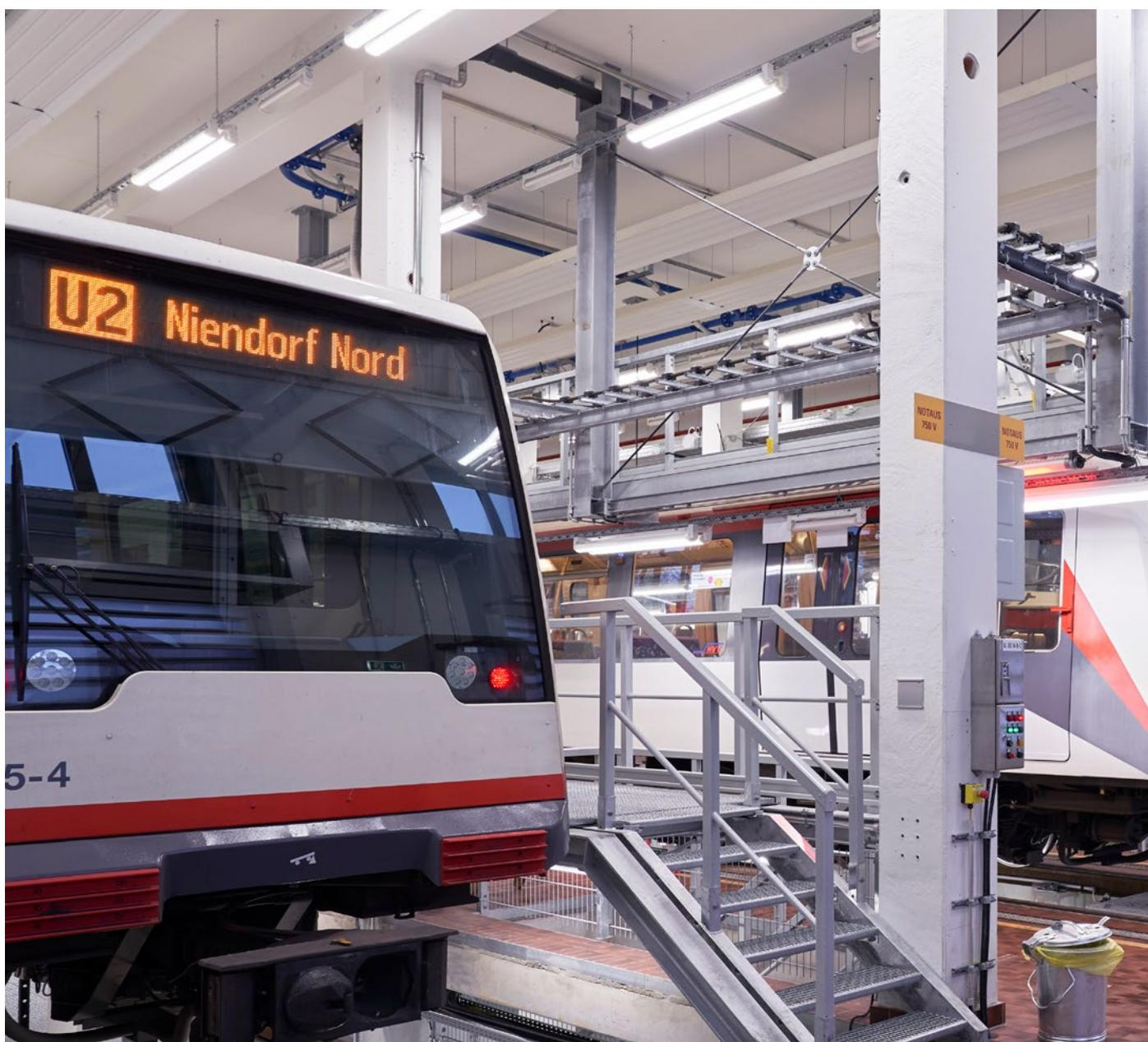
Dans le nouvel atelier ferroviaire de la Hamburger Hochbahn à Billstedt, jusqu'à 26 véhicules peuvent être entretenus et réparés chaque jour. Ils sont ensuite acheminés vers la nouvelle installation de lavage qui a été construite en tant qu'extension côté ouest de l'atelier.
