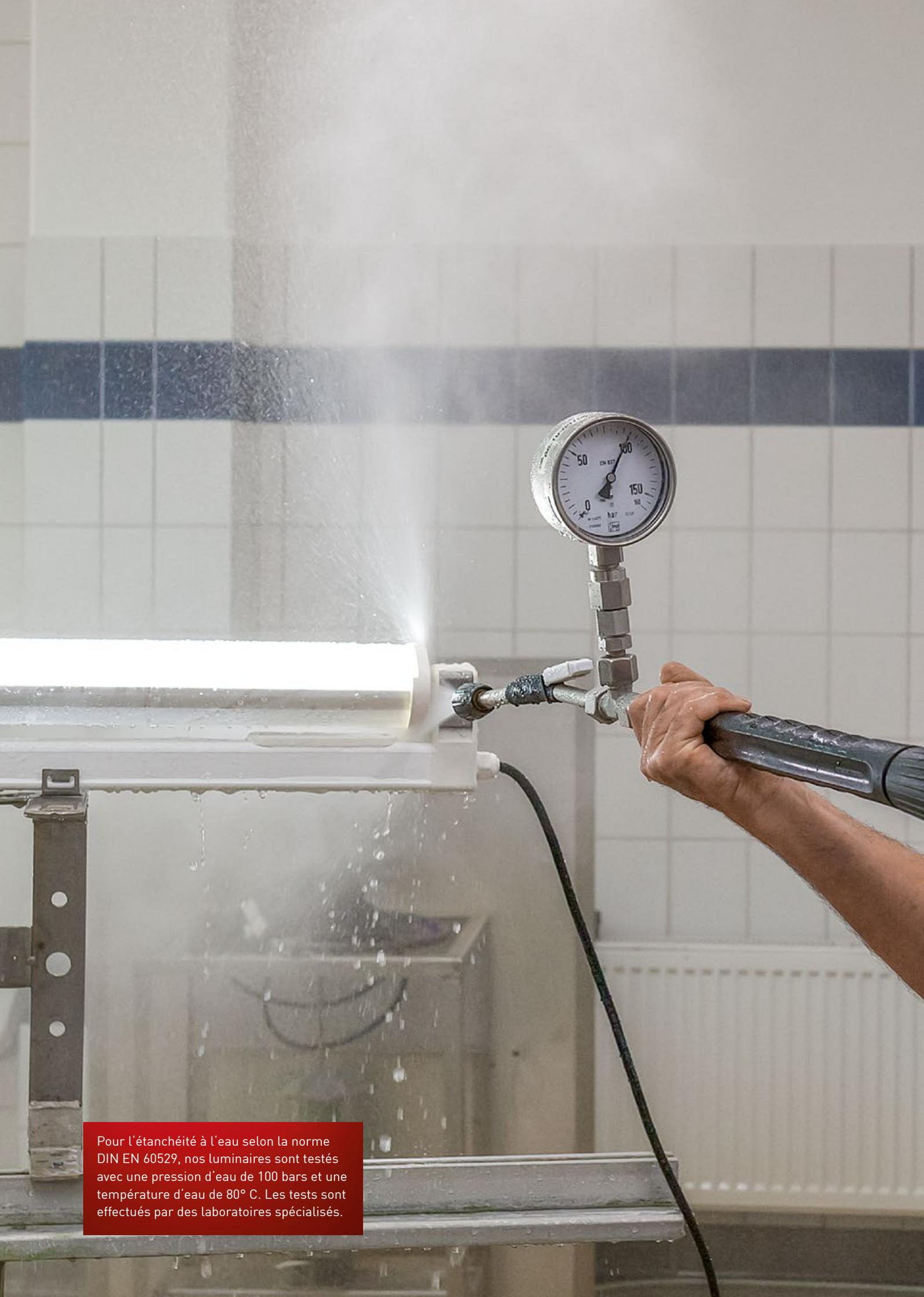
Pour l'étanchéité à l'eau selon la norme DIN EN 60529, nos luminaires sont testés avec une pression d'eau de 100 bars et une température d'eau de 80° C. Les tests sont effectués par des laboratoires spécialisés.
