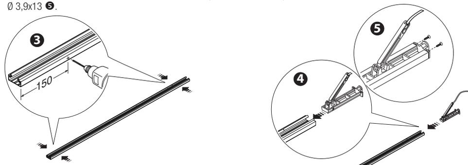
Introduire le profilé en caoutchouc dans le profilé en aluminium jusqu'à la butée du mécanisme **6**.
