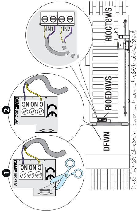
Connexion au module émetteur d'extérieur (806TF-0060)
