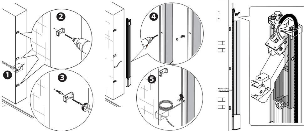
Positionner le bord sensible sur les brides (avec mécanisme de support du micro-interrupteur orienté vers le haut), percer sur les côtés du profilé à l'aide d'une mèche d'un diamètre de  $\varnothing$  2,5 mm ❻ et le fixer à l'aide des vis UNI 6954  $\varnothing$  2,9x13 ❼.
