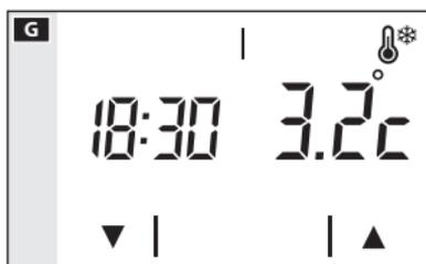
Lorsque l'installation opère en mode antigel **G** (⊞) les flèches permettent de régler la température ambiante minimum tolérée ; la température lue réapparaîtra ensuite.
