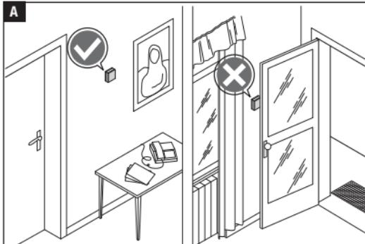
Das Gerät an einer für die Temperaturerfassung geeigneten Stelle montieren (möglichst an einer Innenwand, nicht in Nischen, hinter Türen oder Gardinen oder in der Nähe von Wärmequellen anbringen).
