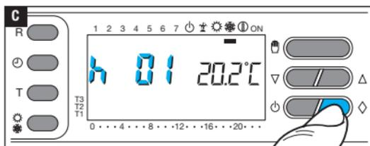
Drücken Sie nun auf die Taste  $\diamond$  **C**. Auf dem Display wird an Stelle der laufenden Uhrzeit, der Schriftzug h01 angezeigt.
