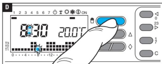
Appuyer sur le bouton
