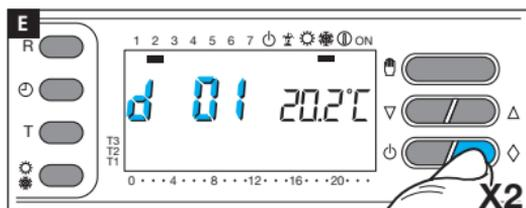
2 Mal auf den Taster  $\diamond$  drücken **E**. Auf dem Display, wird anstelle der aktuellen Uhrzeit d01 angezeigt.
