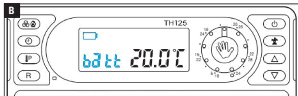
Quand l'écran affiche **batt** +
