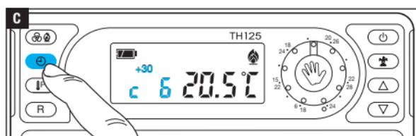
Appuyer plusieurs fois sur le bouton  $\text{clock}$  **C** pour modifier cycliquement le temps de retard entre 15, 30, 45, 0 minutes.
