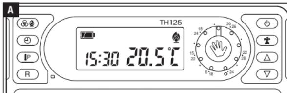
L'absence de l'icône
