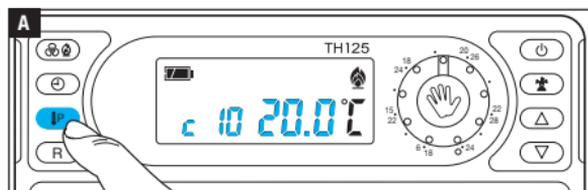
Configurer le mode de fonctionnement AUTOMATIQUE. Appuyer sur le bouton **P** **A**.
