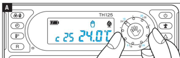
Avec contrôle MANUEL activé **A**, utiliser la bague pour sélectionner la température souhaitée.
