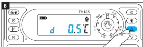
Se servir des boutons  $\Delta$ / $\nabla$  pour configurer la valeur différentielle souhaitée (de  $\pm 0,1^{\circ}\text{C}$  à  $\pm 0,9^{\circ}\text{C}$ ).
