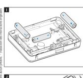
Installer 3 piles alcalines LR03 1,5 V type AAA en respectant les polarités indiquées au fond du logement ...
