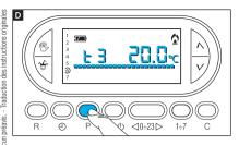
Appuyer sur le bouton P pour confirmer la valeur de la température visualisée à l'écran et pour passer au niveau de température suivant **D**.
