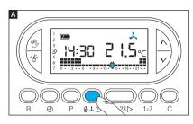
Appuyer sur le bouton **2**. A pour choisir la modalité de fonctionnement de la zone thermique.
