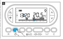
Appuyer sur le bouton ① pour terminer la procédure de configuration de l'heure et du jour ⑤. Les deux points entre les heures et les minutes clignoteront pour confirmer la fin de l'opération.
