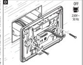
Fixer la base au boîtier à encastrer en faisant passer les câbles de connexion à travers l'ouverture prévue à cet effet **D**.
