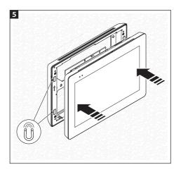
Il est possible d'utiliser les vis et les chevilles fournies pour fixer le support au mur de manière à ce que l'installation du dispositif soit plus solide.
