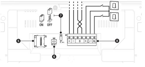
**7** Résistance de terminaison de ligne Le shunt ne doit être activé que dans le dernier dispositif de la ligne.
