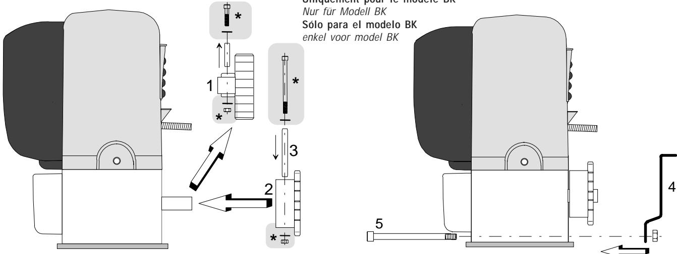
**B) Inserire la catena tra le ruote dentate del motoriduttore e del supporto;**
