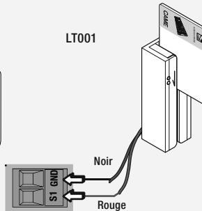
(S1,GND) branchement capteurs TSP00 (transpondeur) LT001 (rampeur).
