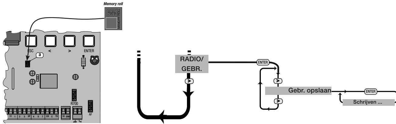
Als de instellingen niet zijn opgeslagen op de "Memory Roll" moeten deze allemaal opnieuw worden uitgevoerd zoals is beschreven in de originele handleiding van het paneel.
