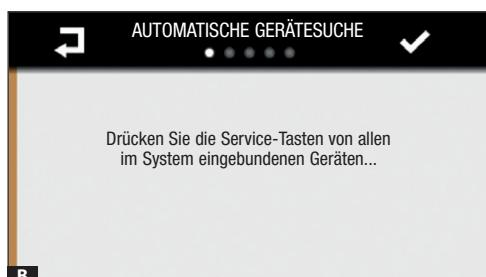
Drücken Sie die "SERVICE"-Taste, auf allen an den BUS angeschlossenen Geräten. Beim Temperaturregler TA/P1 drücken Sie statt der "SERVICE"-Taste gleichzeitig die Tasten .
