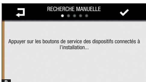
Appuyer sur le bouton « SERVICE » prévu sur tous les dispositifs connectés au BUS. Sur le thermostat de zone TA/P1, à la place du bouton « SERVICE », appuyer en même temps sur les touches  $\nabla\wedge$ .
