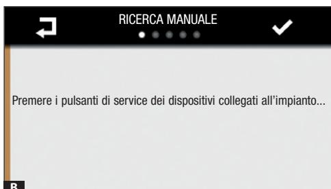
Premere il pulsante "SERVICE" presente su tutti i dispositivi connessi al BUS. Sul termostato di zona TA/P1, in sostituzione al pulsante "SERVICE" premere contemporaneamente i tasti VA.
