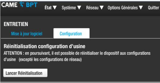
**[CONFIGURATION]** ce menu permet de réinitialiser le dispositif aux configurations d'usine (excepté les configurations de réseau) en appuyant sur la touche **[LANCER RÉINITIALISATION]**.
