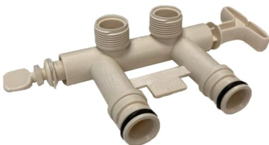
Le by-pass standard permet une grande flexibilité et facilité d'installation. Ultra-résistant, il supporte des pressions de plus de 8 bars. Une vis de cépage intégrée permet de régler le taux de dureté résiduel. Le système poussoir assure le passage eau adoucie à eau dure. Fourni avec clips de fixation et joints toriques.
