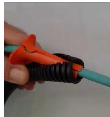
Le passe fibre (vendu séparément) est un accessoire qui facilite la pose et permet de gagner du temps lors du montage.
