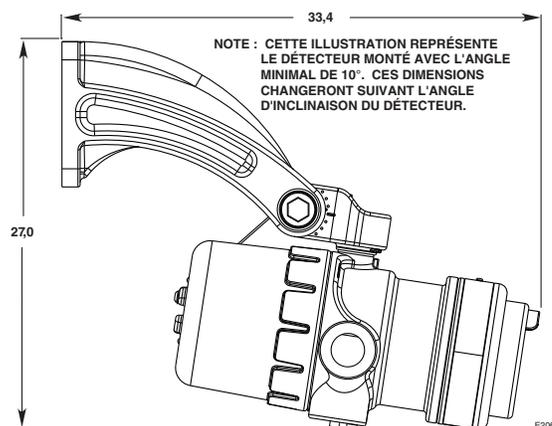
Figure 3—Dimensions du Support de Montage à Rotule Q9033 sans Collier de Fixation (cm)
