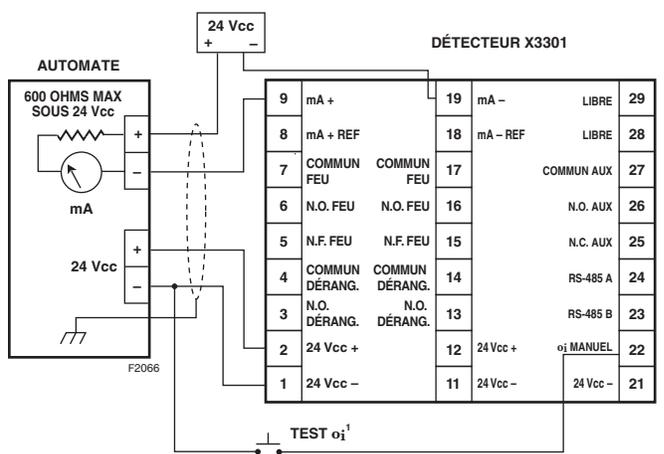
Figure 12—DéTECTEUR X3301 Câblé pour une Sortie 0-20 mA Isolée (Chute)
