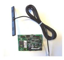
Les systèmes d'alarme I-ON sont destinés aux installations résidentielles et tertiaires. Le cœur du système est constitué d'une unité centrale et de son clavier de commande. Le boîtier de l'unité centrale contient le circuit électronique principal, l'alimentation secteur et l'emplacement pour la batterie.
