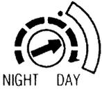
: Pour que le détecteur fonctionne lorsque la zone est plus éclairée, tourner progressivement le potentiomètre vers la position DAY (JOUR).
