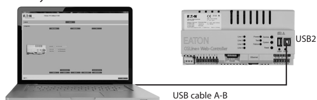
Fig. 3. Connexion d'une centrale à un ordinateur (portable) par port USB A-B
