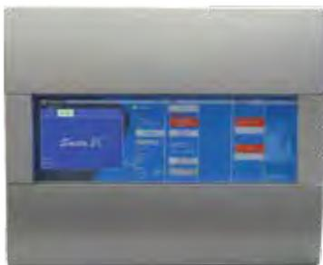
ECS « prêt à installer » permettant la gestion de 128 ou 256 points adressables sur 2 boucles selon version. La centrale est pré-équipée d'une UGA (1 Zone d'Alarme) et d'une alimentation intégrée pour les diffuseurs sonores/ lumineux.
