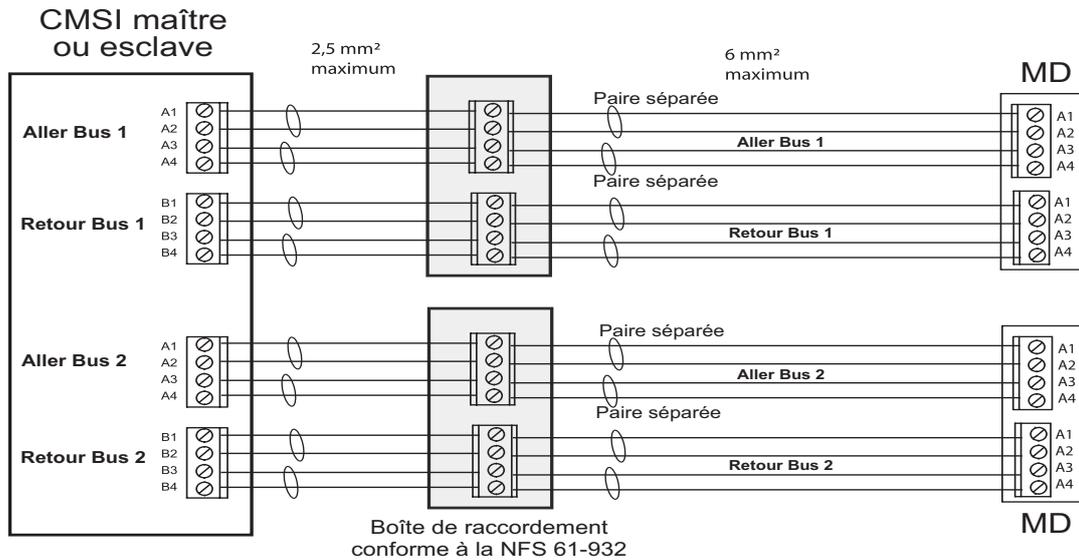
Les câbles du CMSI peuvent cheminer par une boîte de raccordement conforme à la norme NFS 61-932, § 5.33. (Les borniers et l'enveloppe de la boîte de dérivation doivent satisfaire à l'essai du fil incandescent défini dans la norme NF C 20-455.)
