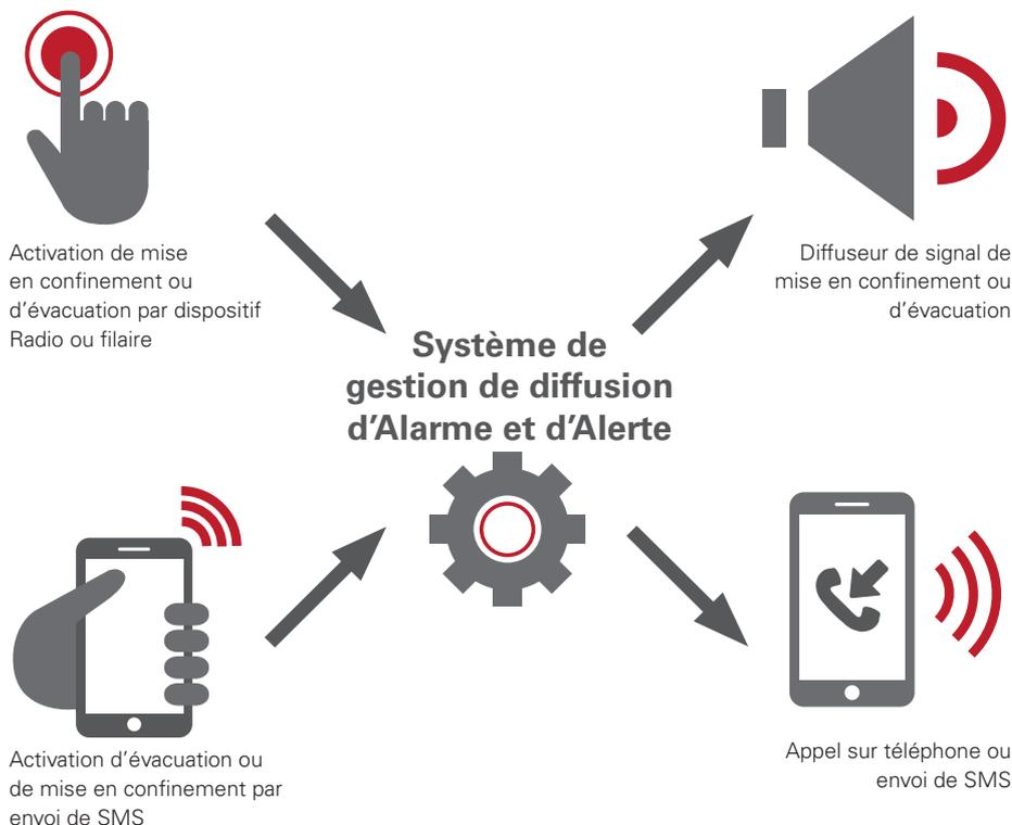
Le système d'alerte est composé de dispositifs de déclenchement, et de dispositifs de diffusion de signal.
