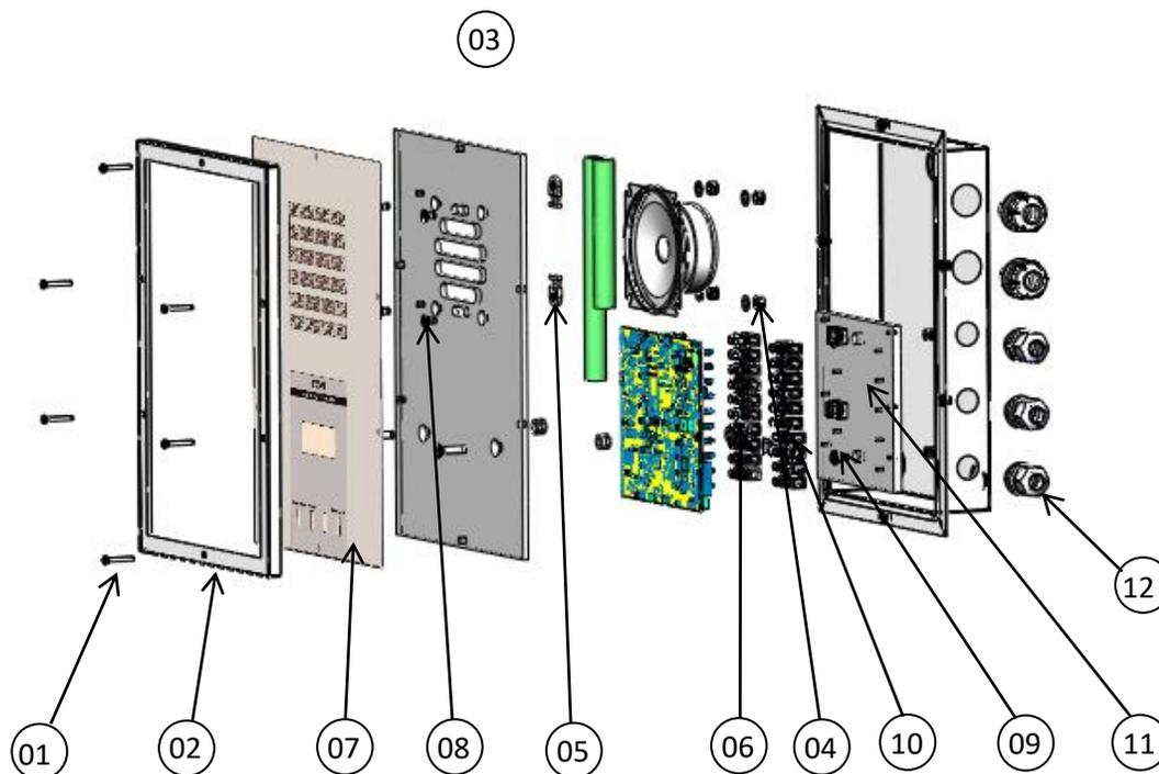
① Pour ouvrir le boîtier, dévisser les 6 Vis M3 qui maintiennent le boîtier fermé.
