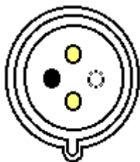
3-polig + PE 220V-240V AC blau
