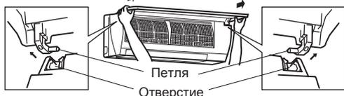
1. Поднимайте переднюю панель до тех пор, пока она не зафиксируется на месте со щелчком.
