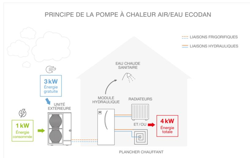
L'installation d'une pompe à chaleur air/eau est simple. Elle est composée de deux éléments :
