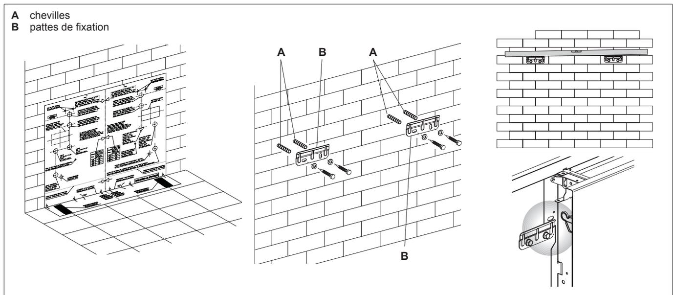
Utiliser le gabarit en papier et marquer sur le plafond l'emplacement des deux pattes de fixation et des deux vis arrière. Percer les trous avec une mèche adaptée et insérer les chevilles (2 par patte); fixer les deux pattes.
