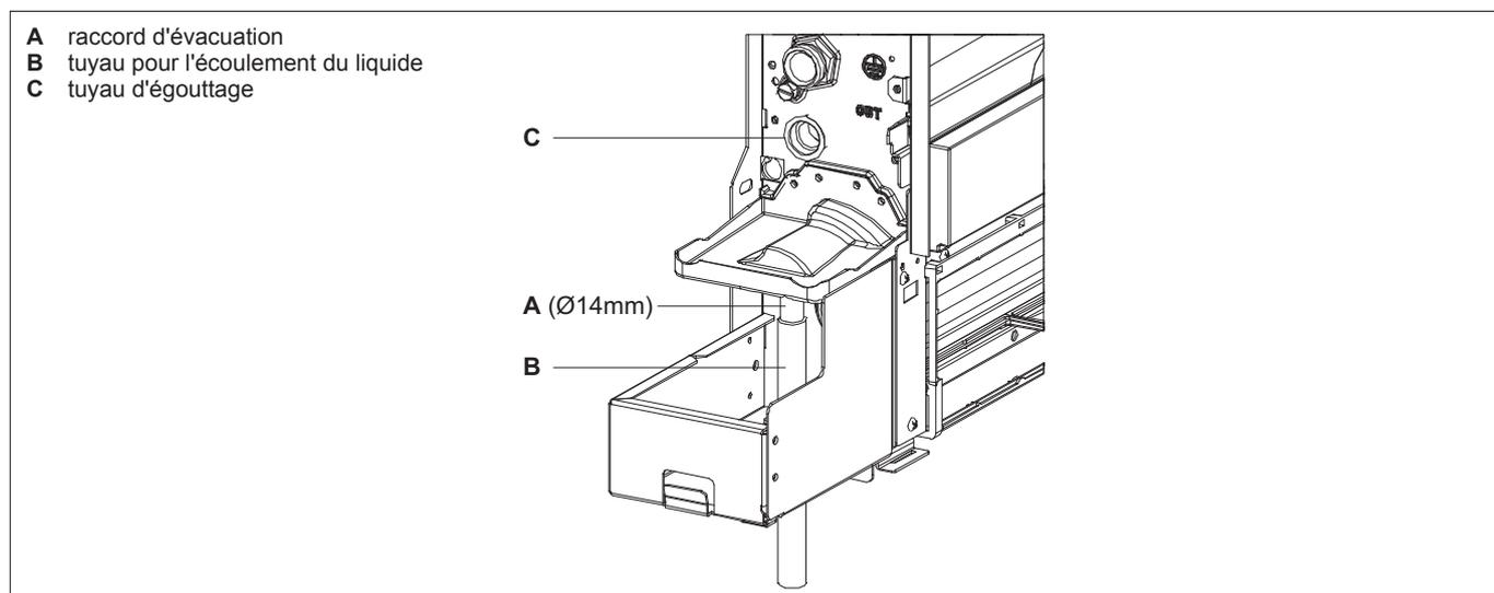
**Montage du tuyau d'évacuation des condensats en position verticale**
