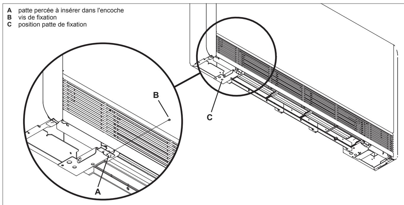
Si le ventilateur-convecteur est installé en position horizontale, pour permettre les opérations de nettoyage/remplacement des filtres, l'installateur doit impérativement monter les deux brides de sécurité qui se trouvent dans le sachet, avec le manuel d'instructions et les accessoires.
