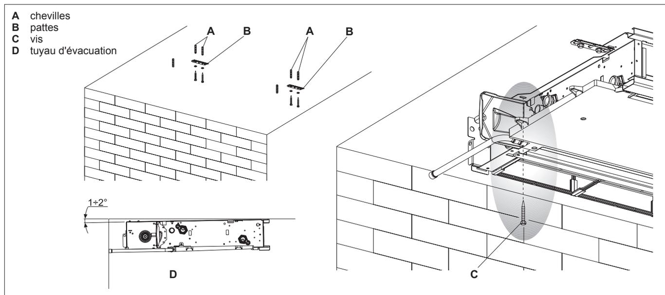
FIXATION GRILLE D'ASPIRATION AVANT (MODÈLES DLMV, DLMO, DLRV)
