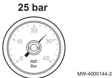
3. Mettre les tuyaux de liaison frigorifique progressivement sous pression jusqu'à 25 bar, par palier de 5 bar.
