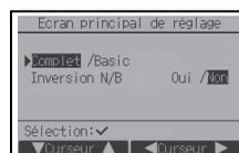
Remarque: Ce réglage n'est prévu que pour l'écran principal de réglage. En mode Basic, les icônes indiquant l'état de contrôle sur les réglages du timer et du programme n'apparaissent pas à l'écran. Les réglages des vannes, des volets et de la ventilation ou la température ambiante n'apparaissent pas.
