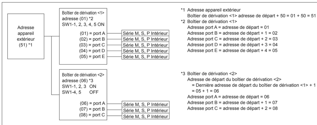
Ex2. Extérieur + Embranchement <1> (Série M, S, P Intérieur A, C, E) + Embranchement <2> (Série M, S, P Intérieur A, C, E)
