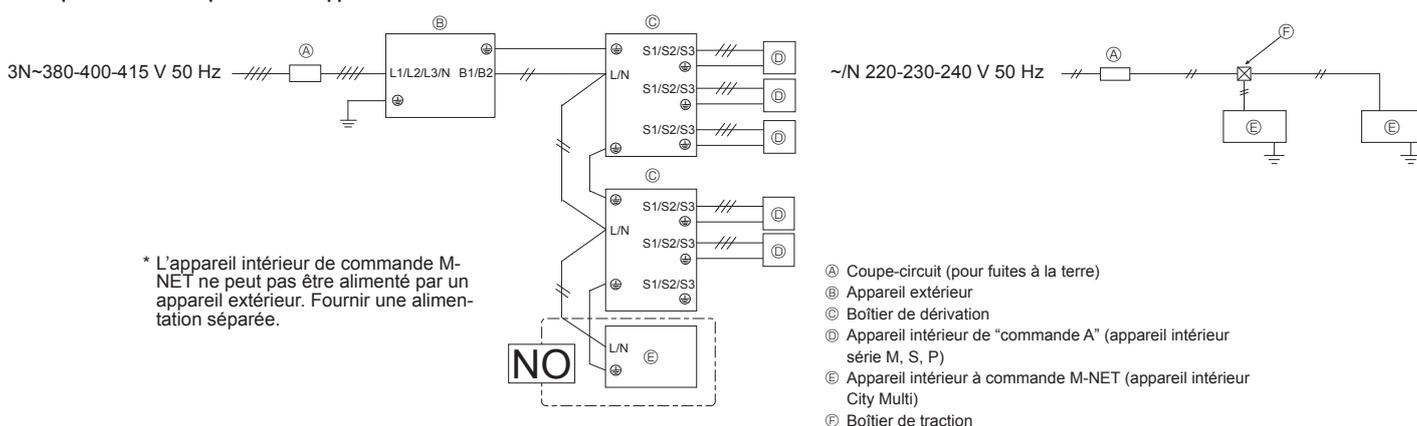
\* L'appareil intérieur de commande M-NET ne peut pas être alimenté par un appareil extérieur. Fournir une alimentation séparée.
