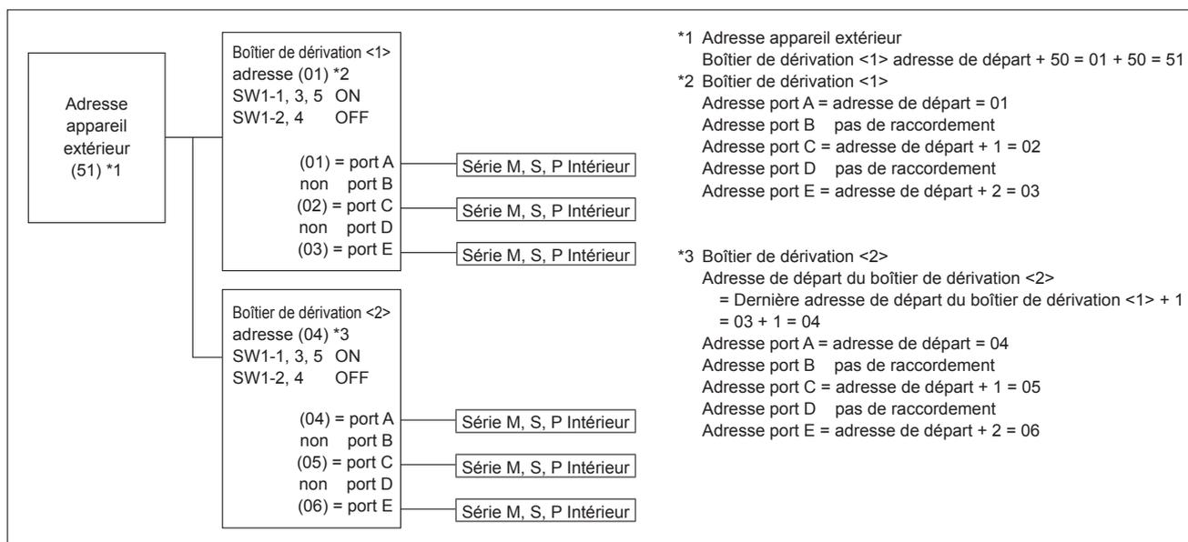
Ex3. Extérieur + Embranchement <1> (Série M, S, P Intérieur A, B, C, D, E) + Embranchement <2> (Série M, S, P Intérieur A, B, C) + Série CITY MULTI Intérieur <1> + Série CITY MULTI Intérieur <2>
