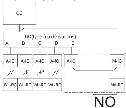
1. Plusieurs appareils intérieurs ne peuvent pas être commandés par une seule télécommande.
