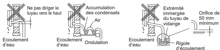
Ne placez pas le tuyau de vidange directement dans une rigole d'écoulement où de l'ammoniac ou du gaz sulfureux peuvent être générés. Le gaz corrosif évaporé peut retourner à l'intérieur par le tuyau de vidange, ce qui peut provoquer une odeur désagréable et une corrosion de l'échangeur thermique.
