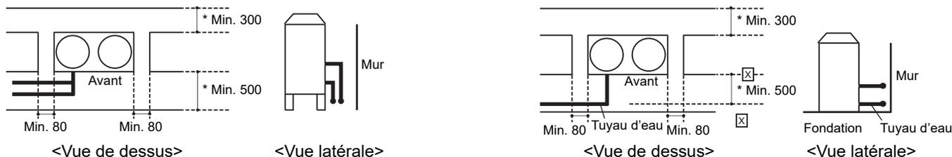
Laissez un espace d'au moins 500 entre l'appareil et le tuyau d'eau s'il n'est pas possible d'installer l'appareil sur une fondation surélevée. (Voir ☒ sur l'illustration.)
