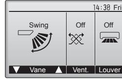
Pressez sur la touche [F1] ou [F2] pour choisir le réglage du déflecteur : "Auto", "Step 1" (Étape 1), "Step 2" (Étape 2), "Step 3" (Étape 3), "Step 4" (Étape 4), "Step 5" (Étape 5), et "Swing" (Balayage). Choisissez le réglage désiré.
