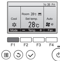
Appuyez sur la touche [F1] pour balayer les modes de fonctionnement parmi : "Cool" (Froid), "Dry" (Déshu.), "Fan" (Ventil.), "Auto", et "Heat" (Chaud). Sélectionnez le mode de fonctionnement désiré.
