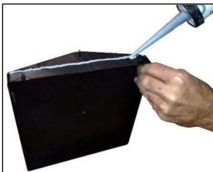
Déposer un cordon de patte d'étanchéité sur la tranche du bac de condensat (figure 01).
