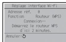
Une fois la connexion du routeur établie, « Terminé » apparaît. Si un message autre que « Terminé » apparaît, vérifiez la connexion et recommencez à partir de l'étape ①, ou reportez-vous au manuel de l'interface Wi-Fi.
