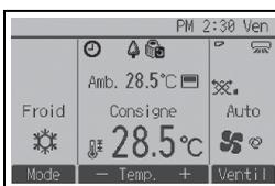
Écran principal de réglage en mode Complet sur le contrôleur à distance principal (unité en fonctionnement)
