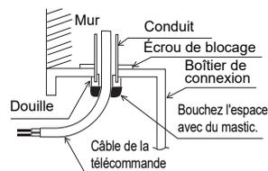
Pour prévenir tout risque d'électrocution, de dysfonctionnement ou d'incendie, comblez l'espace entre les câbles et les trous d'accès des câbles avec du mastic.
