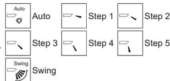
Sélectionnez "Swing" (oscillation) pour déplacer les ailettes de haut en bas automatiquement. Lorsqu'elle est réglée sur "Step 1" (Étape 1) à "Step 5" (Étape 5), l'aillette reste fixe à l'angle sélectionné.
