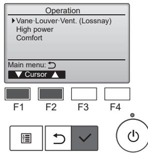
Sélectionnez "Vane•Louver•Vent. (Lossnay)" (aillette louvre évent (Lossnay)) ou "Vane•3D i-See•Vent. (Lossnay)" (Ailette 3D i-See Évén (Lossnay)) dans le menu Operation (Fonctionnement) et appuyez sur la touche [CHOIX].
