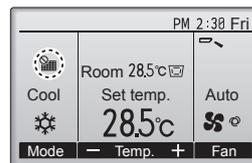
Lorsque le filtre est affiché sur l'écran principal en mode complet, le système est piloté de façon centralisée et le témoin d'état du filtre ne peut pas être remis à zéro.
