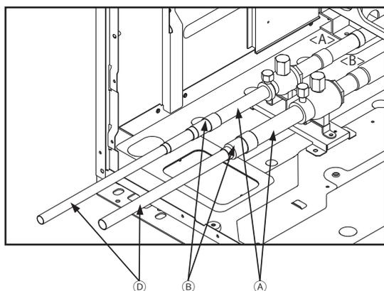
(2) Lors de l'acheminement des tuyaux par la partie inférieure de l'appareil
