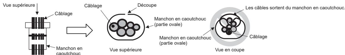
\*2 Quand vous insérez le câblage dans le manchon en caoutchouc, assurez-vous que ce dernier ne se détache pas de la tôle du boîtier de commande.
