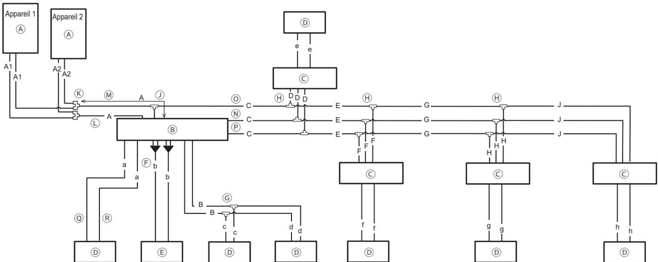
Modules de combinaison d'un contrôleur BC principal avec des contrôleurs BC secondaires (de type M-JA1, P-KA1 et M-KB1)
