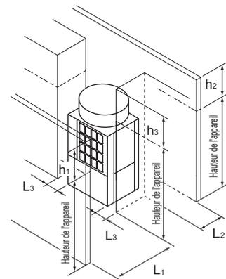
Si la hauteur des murs autour de l'appareil dépasse la limite de hauteur, ajoutez la moitié de la hauteur qui dépasse la limite ( $h_1/2-h_3/2$ ) à  $L_1$ ,  $L_2$  et  $L_3$  comme indiqué dans le tableau ci-dessous.
