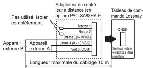
Appareil externe A : Capteur de CO<sub>2</sub> tiers / BMS / Capteur de pression tiers (pour le contrôle de la pression constante de l'air refoulé)
