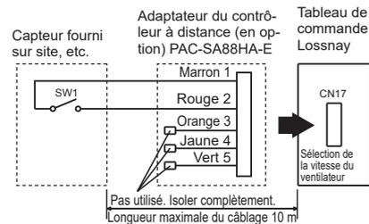
Utilisez ce réglage de façon à ce que la ventilation s'accomplisse normalement à la vitesse basse du ventilateur et lorsque le capteur externe détecte la pénétration d'air intérieur, ou lorsque SW1 est activé, le ventilateur passe à la vitesse haute de fonctionnement. Lorsque plusieurs unités Lossnay sont contrôlées par une seule entrée, la série PZ-62DR est nécessaire.
