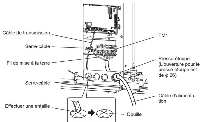
Veillez à serrer le fil de terre à la vis de mise à la terre à l'aide des cosses rondes avec rondelle anti-écartement.
