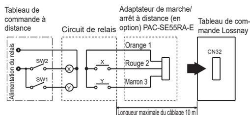
SW1 : S'il est activé, il est impossible de mettre l'unité Lossnay sous ou hors tension à partir du contrôleur à distance (série PZ-62DR).
