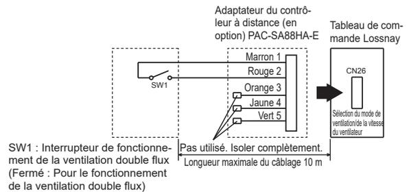
Si SW1 est sur "ON", le mode de ventilation de l'unité Lossnay passe à la ventilation double flux quel que soit le réglage du contrôleur à distance.
