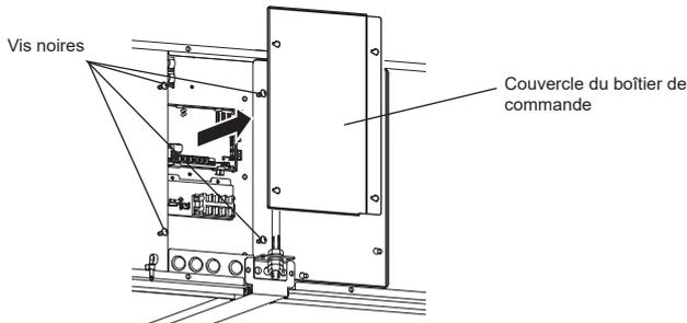
(2) Raccordement du câble d'alimentation et du câble de transmission.
