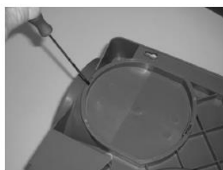
À l'aide d'un tournevis plat, déclipper le bouchon.
