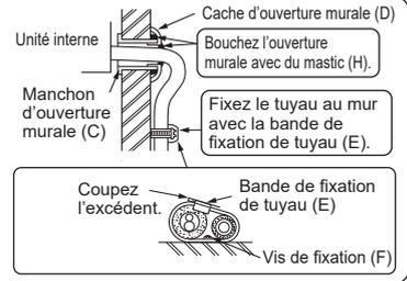
Après le test de contrôle des fuites, appliquez soigneusement du matériau isolant pour obstruer les trous. Les connexions mécaniques seront accessibles aux fins de maintenance.
