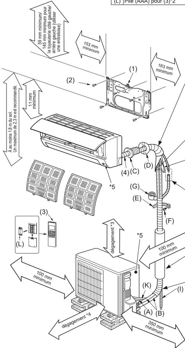
Veillez à utiliser le manchon d'ouverture murale (C) pour éviter tout contact entre le câble de connexion de l'unité interne/externe (A) et les pièces métalliques du mur ou toute détérioration causée par les rongeurs si le mur est creux.
