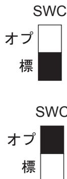
Grâce à cette fonction, l'air est pulsé simultanément des sorties d'air supérieure et inférieure de façon à refroidir ou chauffer rapidement la pièce. Vous pouvez sélectionner cette fonction grâce au commutateur SWC situé sur le panneau de l'adresse.
