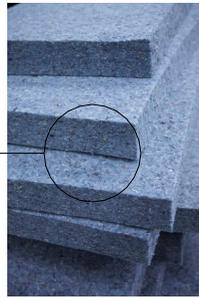
REMPLEISSAGE PAR MATERIAU ACOUSTIQUE A BASE DE FIBRES TEXTILES RECYCLEES COMPRIMEES
