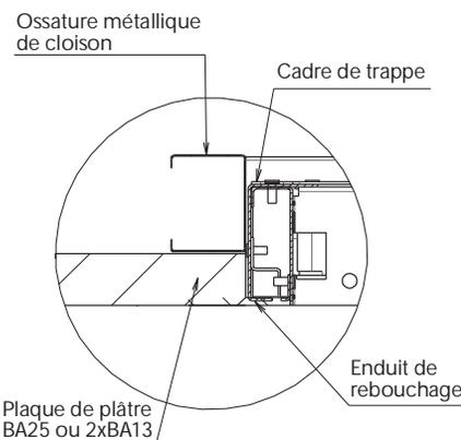
Détail de coupe horizontale, intégration de la trappe dans la cloison de plaques de plâtre
