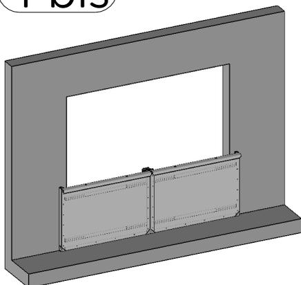
Présenter les batardeaux devant l'ouverture. Insérer les tirants dans les crans des équerres et du poteau.
