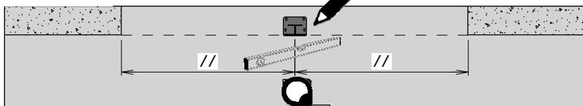
Centrer le poteau dans l'ouverture et aligner la face avant avec la façade.
