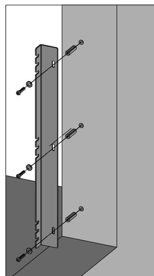
Percer suivant les repères tracés avec une mèche adaptée de diamètre 16mm à une profondeur mini de 65mm.
