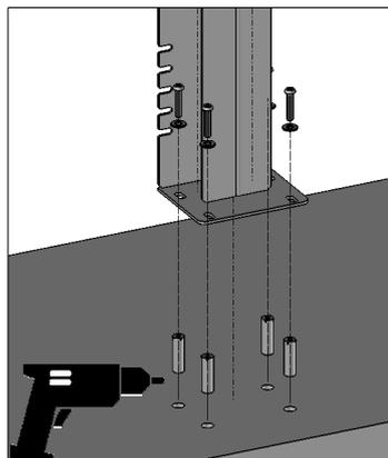
Percer suivant les repères tracés avec une mèche adaptée de diamètre 16mm à une profondeur mini de 65mm.
