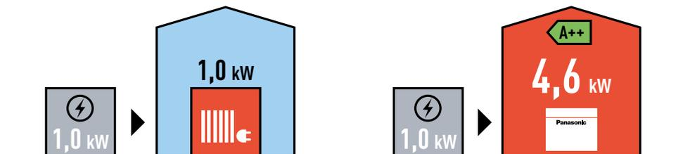
La pompe à chaleur utilise l'énergie thermique extérieure pour l'amener à l'intérieur. La nouvelle console peut chauffer même à une température extérieure de -15 °C.
