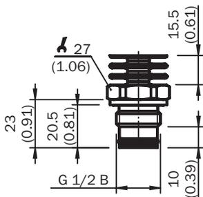
Boîtier avec connecteur cylindrique M12 x 1
